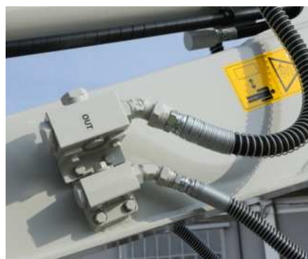
Rubinetti all'uscita dell'impianto ausiliario per evitare spillamenti e perdite di pressione in fase di installazione / disinstallazione delle attrezzature.
