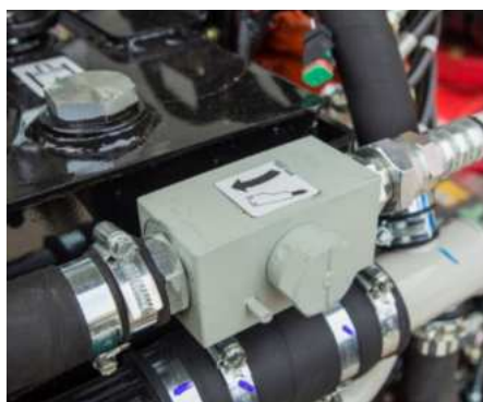
Rubinetto selettore impianto ausiliario doppio effetto (per pinza, trincia) o singolo effetto (martello).
