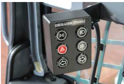
PULSANTIERA CIRCOLAZIONE STRADALE
